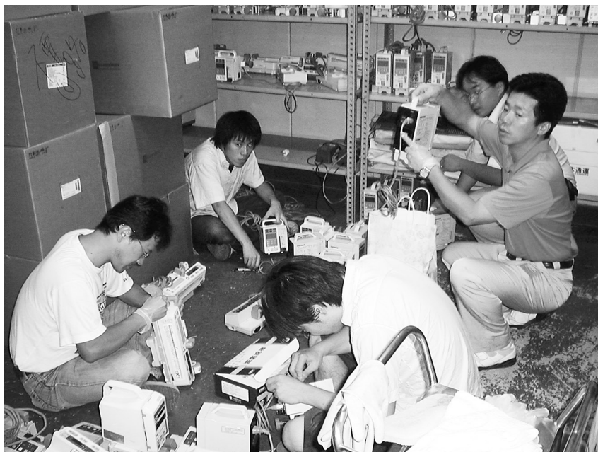
医療機器支援品の輸液ポンプ・シリンジポンプのメンテナンスをするメディカルエンジニアのみなさん (JCF事務局倉庫にて)
